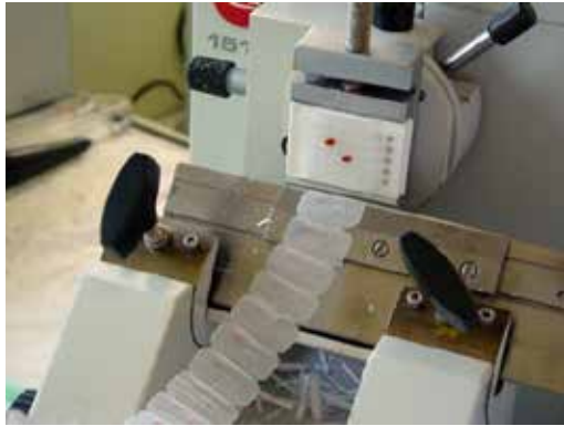
Snijden van 4 micron dunne plakjes voor de coupe
